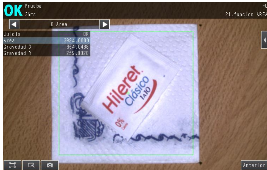
Pantalla de PREUBA. Muestra la imagen sobre la que se aplica la herramienta AREA
