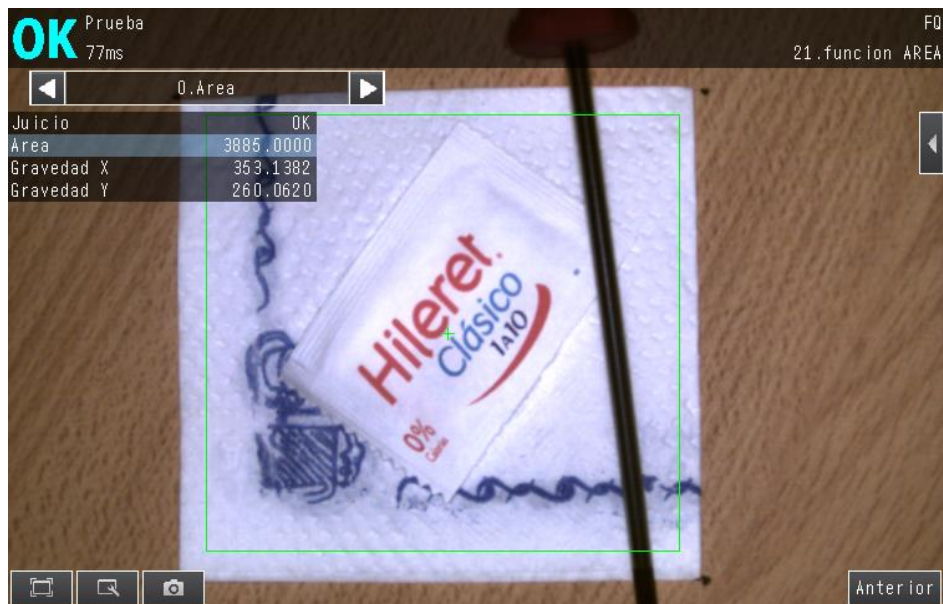
Pantalla de PREUBA. Hay un objeto extraño que no interfiere sobre las áreas de color rojo. La salida es OK.
